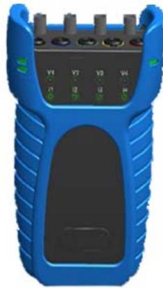
电能记录分析仪 Pure BlackBox——单相和三相的轻质手持移动式设备，非常容易地在插座上插拔使用，连续记录每一个周波所有的数据不需要设置阈值，快速 USB 连接到 PC 机进行分析，可以在民用、电力和工业场合以及高校教学中广泛应用。
